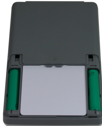
Kontaktierereinheit 2 gesteckte Karte von der Unterseite im Batteriefach
