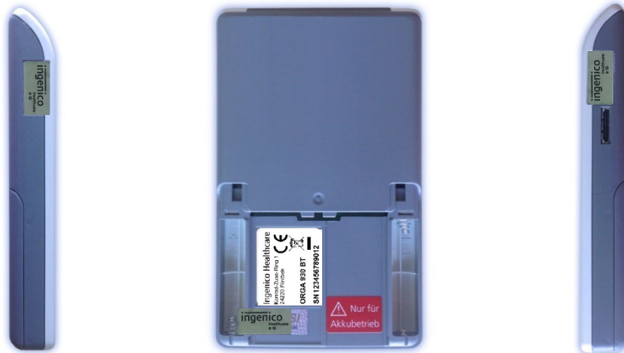
Abbildung 4: Positionen der drei Gehäusesiegel am Gehäuse des Gerätes
