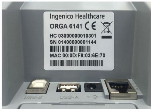
**Abbildung 8:** Typenschild mit zulässigem Herstellcode HC 0300000010301 oder HC 0300000020301
