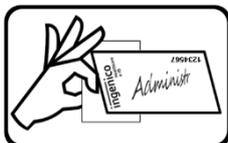
Die verbleibende Hälfte des Trägerblattes dient als Anfasslasche. Geben Sie darauf Acht, dass die selbstklebende Siegelunterseite nicht direkt mit Ihren Fingern oder anderen Gegenständen in Berührung kommt, da sie sehr empfindlich ist und das Slotsiegel so sehr leicht beschädigt werden kann.
