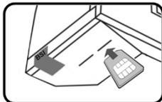
Setzen Sie die SMC-Karten wie oben beschrieben in die Kontaktiereinheiten 3 und 4 ein. In welche Kontaktiereinheit Sie die gSMC-KT oder SMC-B Karte einsetzen, spielt keine Rolle.
