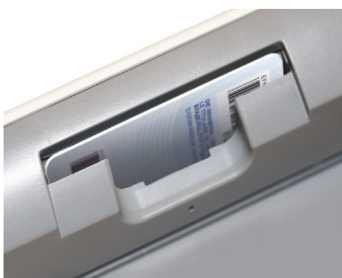
Abbildung 19: Der HBA in der Kontaktiereinheit 2
