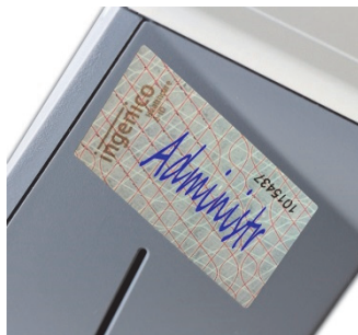
Abbildung 23: Die richtige Positionierung des Slot-siegels
