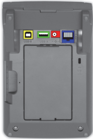
Abbildung 26: Anschlüsse auf der Unterseite des Gerätes
