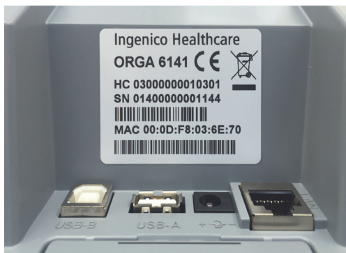
Abbildung 8: Typenschild mit Herstellercode HC 03000000010301
