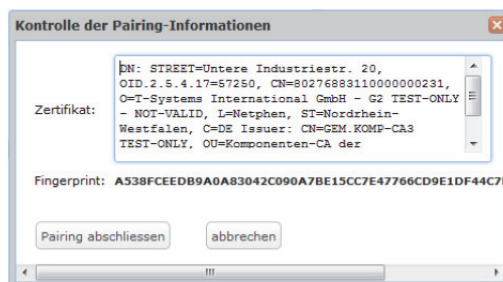
Abbildung 24: Beispiel der Angabe des gSMC-KT Fingerprints im Konfigurationsmenü eines Konnektors
