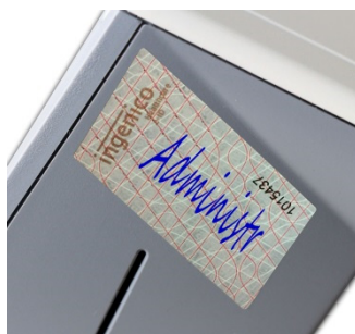
Abbildung 23: Die richtige Positionierung des Slot-siegels
