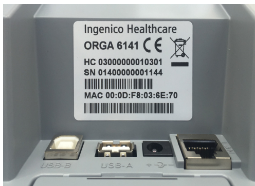
Abbildung 8: Typenschild mit Herstellercode HC 03000000010301
