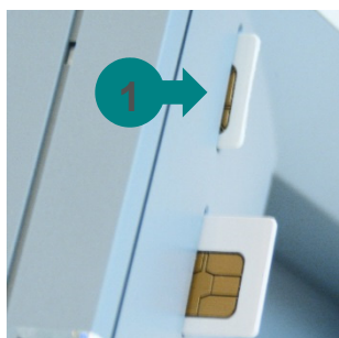
Abbildung 22: Einsetzen der SMC-Karten in die Kontaktiereinheit 3 und 4
