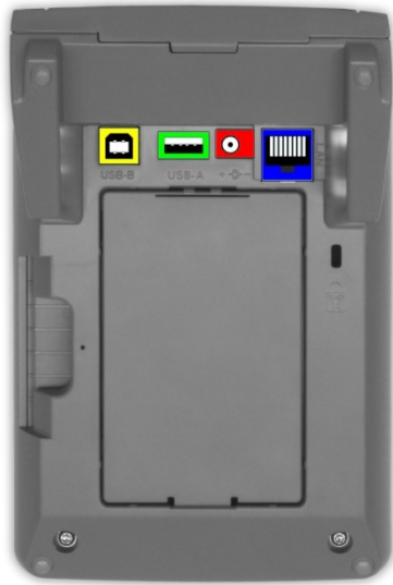
Abbildung 26: Anschlüsse auf der Unterseite des Gerätes
