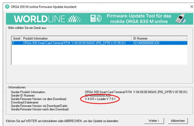
Damit ist die Installation der neuen Firmware 4.9.0 abgeschlossen. Das Kartenterminal kann jetzt weiterverwendet werden.
