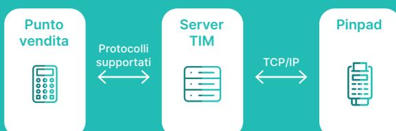
Utilizzata per supportare vari protocolli ECR e tradurli in un protocollo generale per comunicare con l'applicazione di pagamento. Usata per diverse soluzioni.
