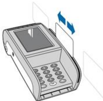
Figuur E: Magneetstrooklezer schoonmaken
