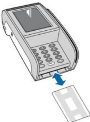
Figuur D: Chiplezer schoonmaken
