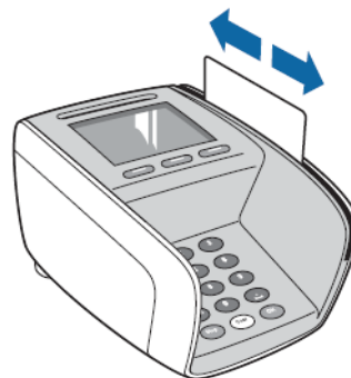
Figuur G: Magneetstrooklezer schoonmaken
