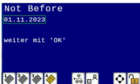
**Abbildung 46:** Parameterabfrage „Not Before“ (Startdatum) zur Neuerstellung des RMI-Zertifikats (7/10)
