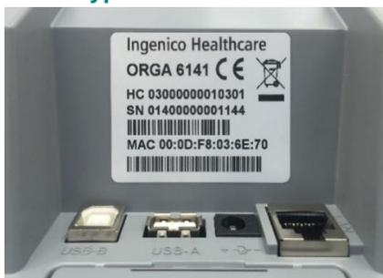
**Abbildung 8:** Beispiel - Typenschild mit zulässigem Herstellcode HC 0300000010301 oder HC 0300000020301
