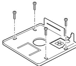
Avvitamento della piastra di fissaggio
