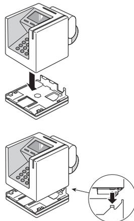
Per finire spingere con precauzione il terminale verso il lato posteriore finché scatta il dispositivo di bloccaggio.
